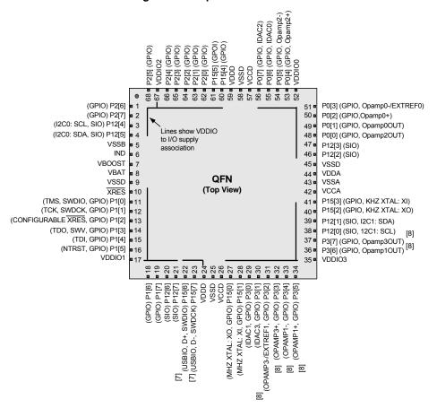
Figure 2-5. 68-pin QFN Part Pinout<sup>[9]</sup>
