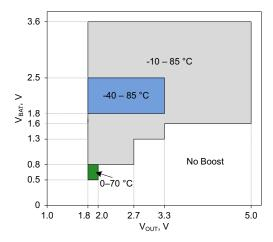
Figure 11-10.  $L_{\text{BOOST}}$  values over  $V_{\text{BAT}}$  and  $V_{\text{OUT}}$
