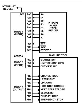
FIGURE 24. MACHINE TOOL CONTROLLER INTERFACE
