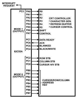
FIGURE 22. BASIC CRT CONTROLLER INTERFACE
