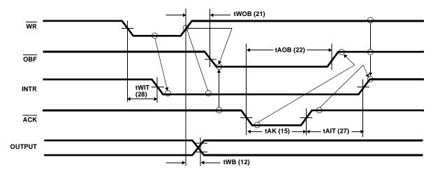
FIGURE 28. MODE 1 (STROBED OUTPUT)
