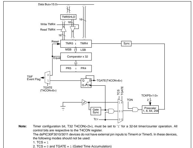
FIGURE 11-2: 16-BIT TIMER4 BLOCK DIAGRAM (TYPE B TIMER)
