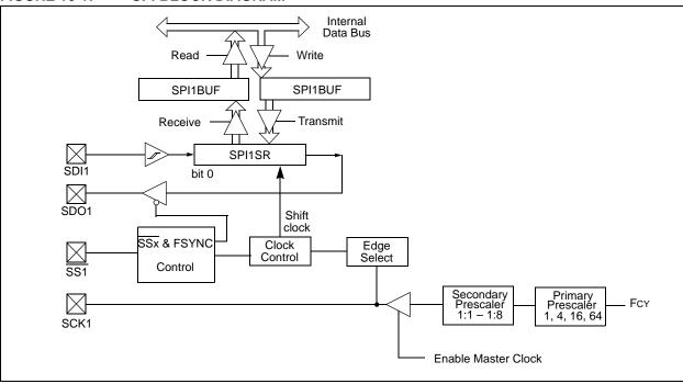
FIGURE 16-2: SPI MASTER/SLAVE CONNECTION
