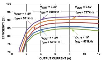
FIGURE 5. EFFICIENCY, V<sub>IN</sub> = 9V, FOR VARIOUS OUTPUT VOLTAGES
