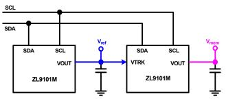
FIGURE 16. PMBUS TRACKING CONFIGURATION
