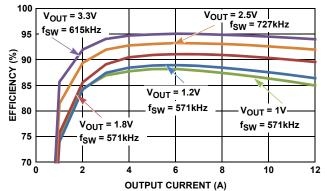
FIGURE 4. EFFICIENCY, V<sub>IN</sub> = 5V, FOR VARIOUS OUTPUT VOLTAGES
