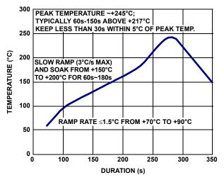
FIGURE 22. TYPICAL REFLOW PROFILE
